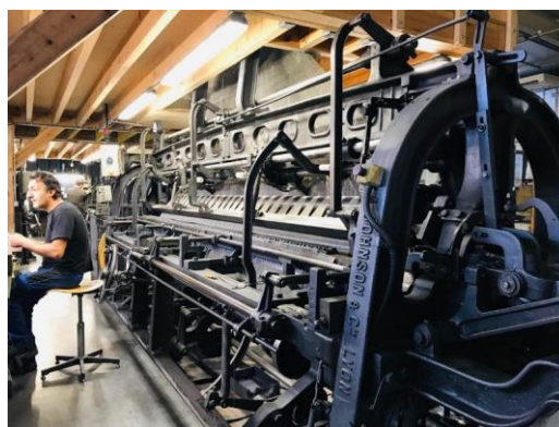
Métiers permettant la fabrication de la dentelle de Caudry, manufacture Jean Bracq
